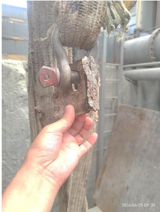
图 6 掉落的吊耳、尼龙带吊具及连接 U 型卡
