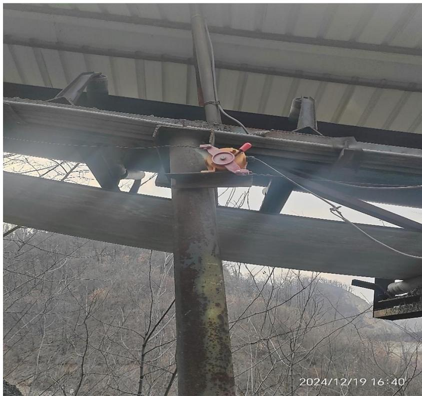
图 6 3#带式输送机设置的事故拉绳开关
